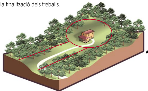
Fig. A / B: Franja de seguretat de 50 metres d'amplada mínima lliure de residus, i vegetació seca que actua de zona de defensa.
